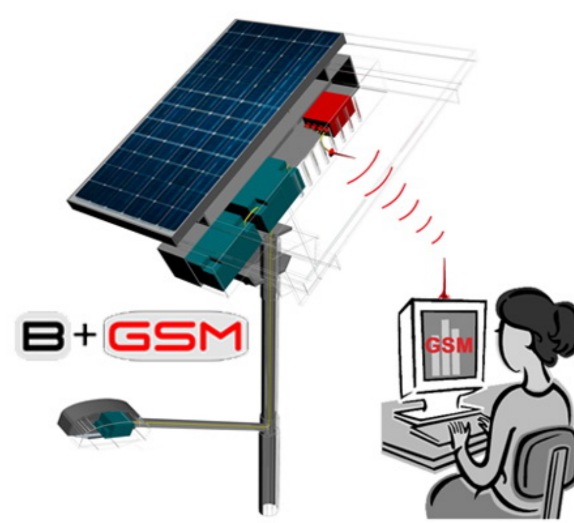
Lampione FV stradale con controllo GSM PV Street lamp-GSM version
